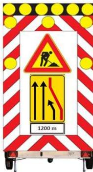
Figura 6: fig. Il 400 per la chiusura di una o più corsie di transito (la figura esemplifica la chiusura della corsia di marcia in dx). E' integrato con set di 6 lampade a led ad alta efficienza luminosa diam. 300 mm (con possibilità di lampeggio sincrono e sequenziale)
