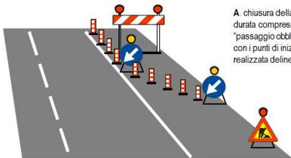
A chiusura della corsia di emergenza con durata compresa tra 2 e 7 giorni. Le frecce "passaggio obbligatorio a sinistra" coincidono con i punti di inizio e fine della diagonale realizzata delineatori flessibili.
