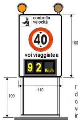
Figura 11: cartello dissuasore su cavalletto con rilevatore radar di velocità (misure indicative)
