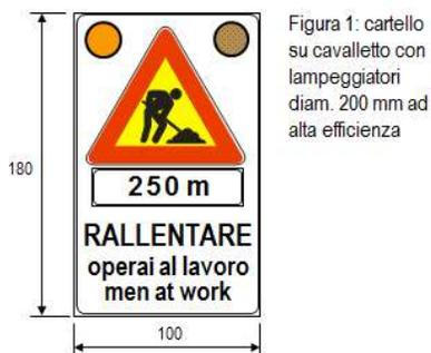
Figura 1: cartello su cavalletto con lampeggiatori diam. 200 mm ad alta efficienza
